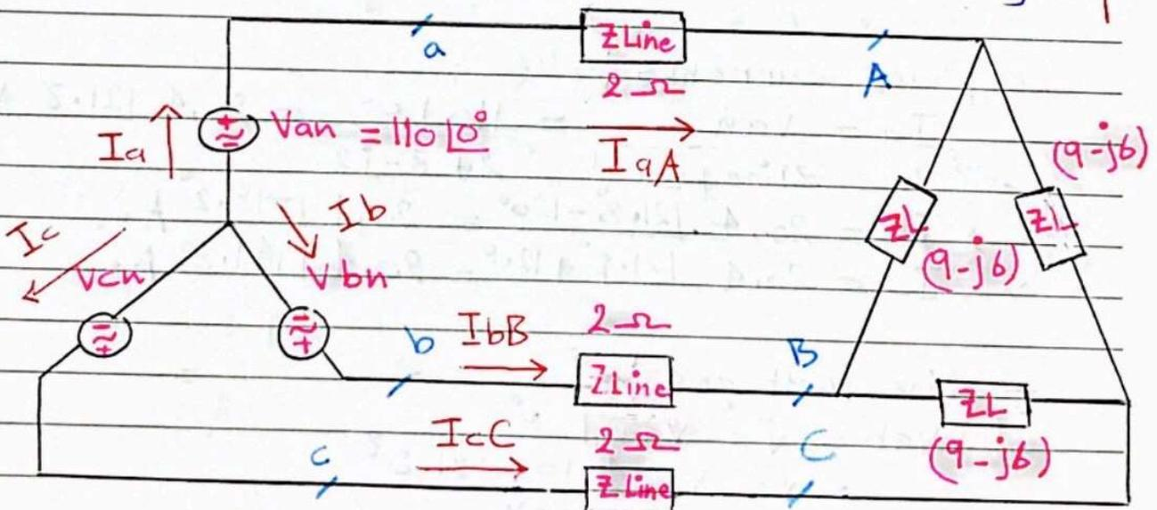
مبتغاهون لازم احوالمن توهميلة [Y-Δ connected] إلى توهميلة [Y-Y connected] لأنه يوجد  $(Z_{\text{Line}})$ .
