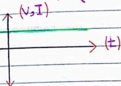
← وهي عبارة عن دوائر كهربائية فيها (التيار والجهد الكهربائي) لا يتغيران مع مرور الزمن ، (مقدارًا واتجاهًا) .
