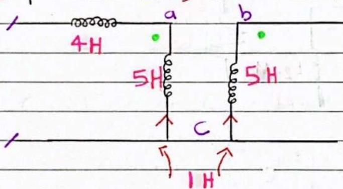
The T-equivalent circuit :-
