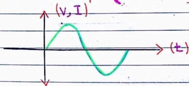
← وهي عبارة عن دوائر كهربائية فيها (التيار والجهد الكهربائي) يتغيران مع مرور الزمن ، (مقدارًا واتجاهًا) .
